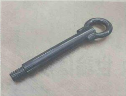
故障車を移動する際などに使用されるけん引フック
